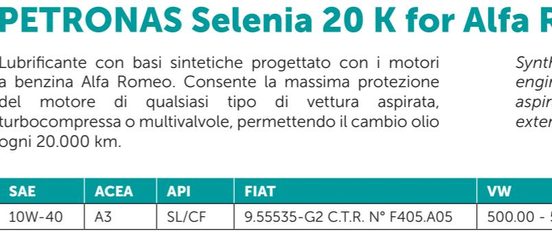
Lubrificante con basi sintetiche progettato con i motori a benzina Alfa Romeo. Consente la massima protezione del motore di qualsiasi tipo di vettura aspirata, turbocompressa o multivalvole, permettendo il cambio olio ogni 20.000 km.
