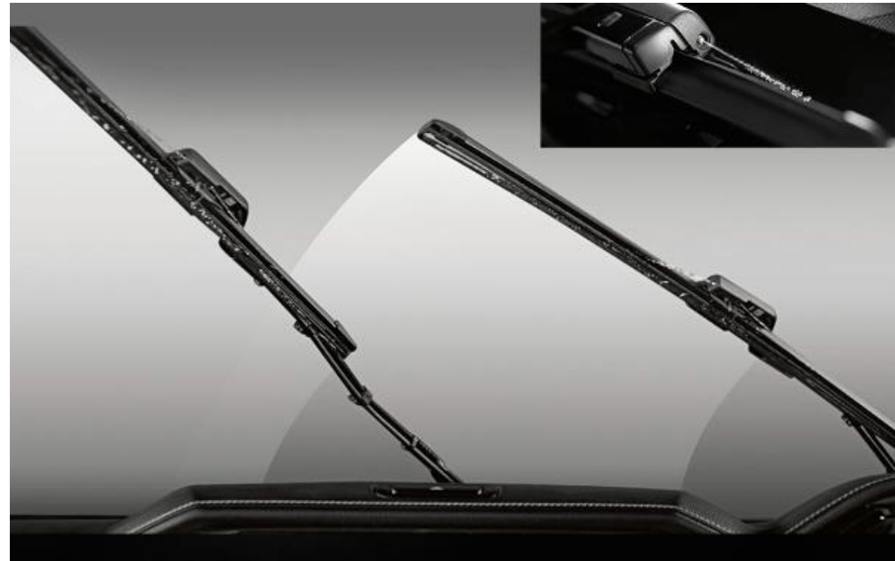
Integrert spyler i visker og regnsensor
